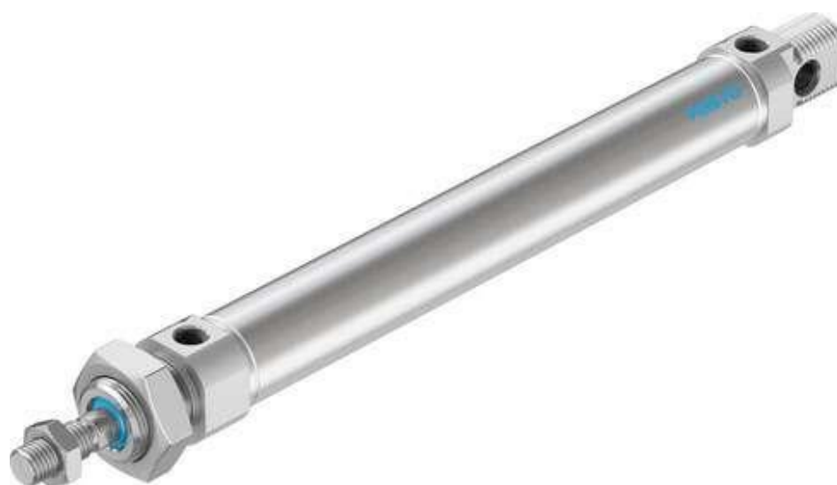
Рис.3.4. Пневмоциліндр Festo DSNU-25-160-PPV-A, DSNU – стандартний циліндр двосторонньої дії, 25 – поршень, мм, 160 – хід, мм, ppv
