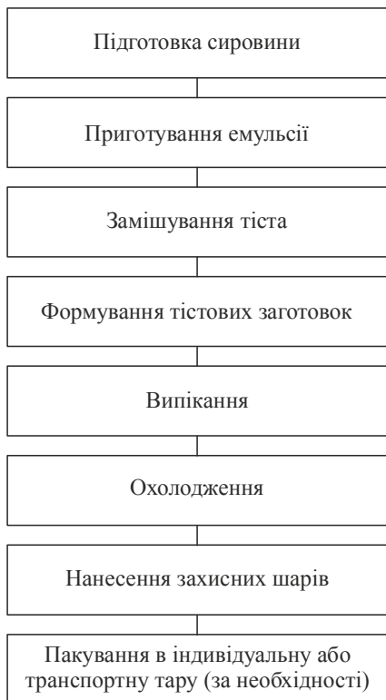
Рис. 3. Принципова схема виробництва борошняного їстівного посуду
