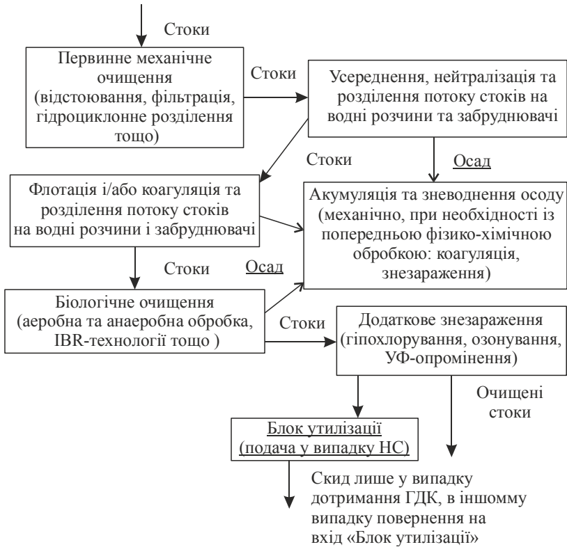
Рис. 1. Варіант комбінованого комплексу електротехнологічних процесів очищення стоків харчових виробництв з урахуванням дії НС (осад блоку первинного механічного очищення подається на блок опрацювання осаду)
