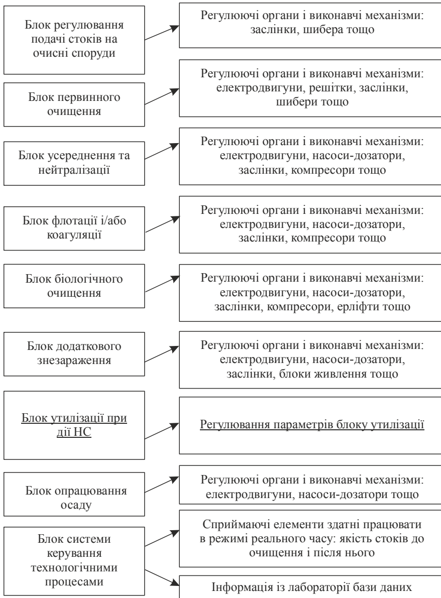
Рис. 2. Структура електротехнологічного комплексу реалізації процесів очищення стоків харчових виробництв з урахуванням нештатних ситуацій
