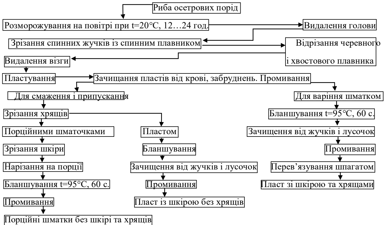
Рис. 1.2 – Технологічна схема розбирання риби з хрящовим скелетом
