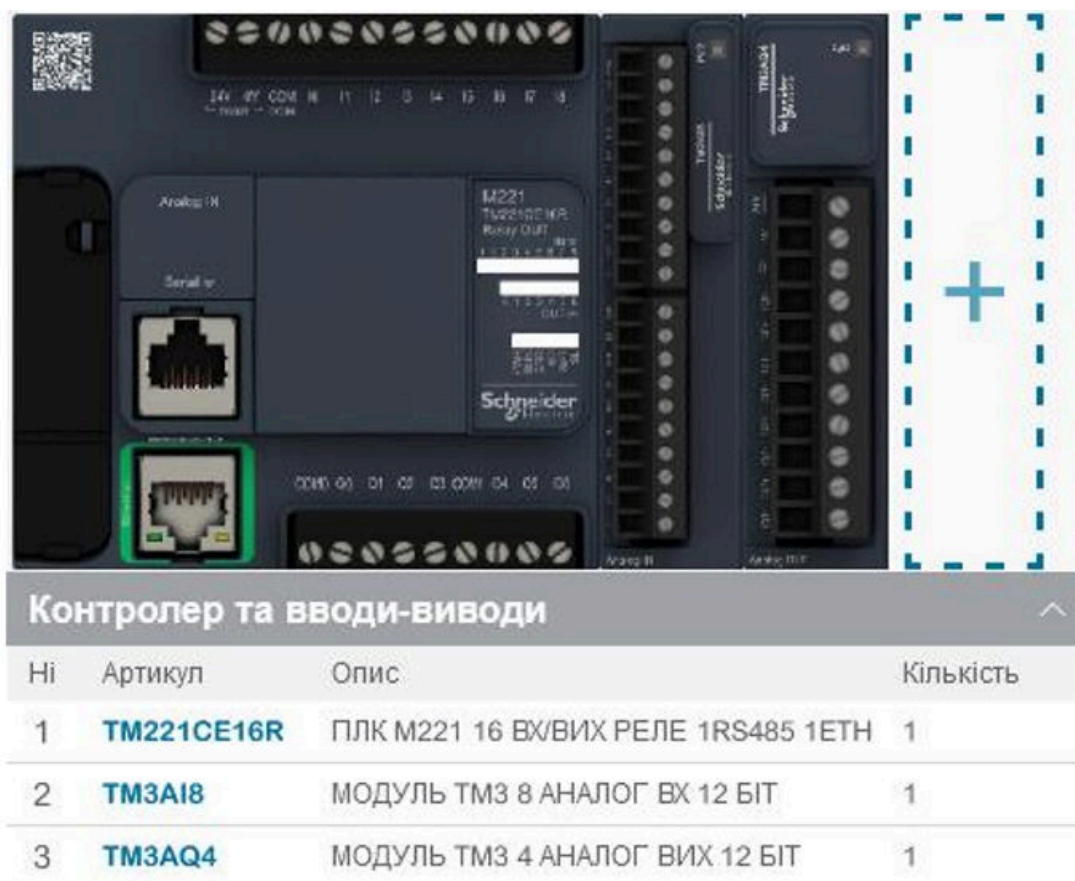
Рис. 3.1. Конфігурація модулів ПЛК ПСТ Schneider Electric M221.
