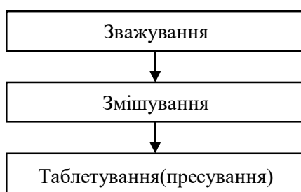
Рис.2.1. Етапи виробництва таблеток методом прямого пресування
