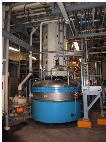
Рис.5.4. Зовнішній вигляд та графічне позначення на апаратурній схемі нутч-фільтру продуктивністю 6,5 м 3
