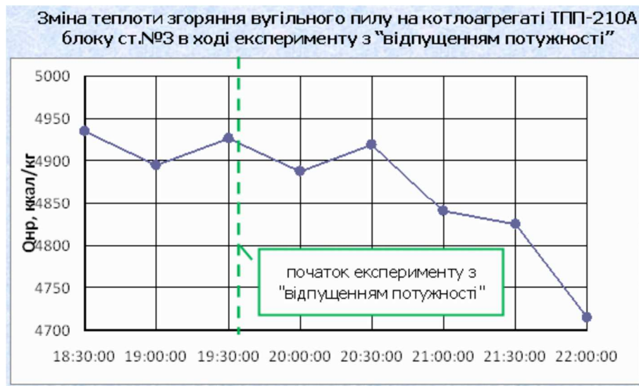
Рисунок 3.9 – Зміна теплоти згоряння вугілля (котлоагрегат ТПП-210А, корпус 3Б) під час дослід з “відпущенням потужності”.
