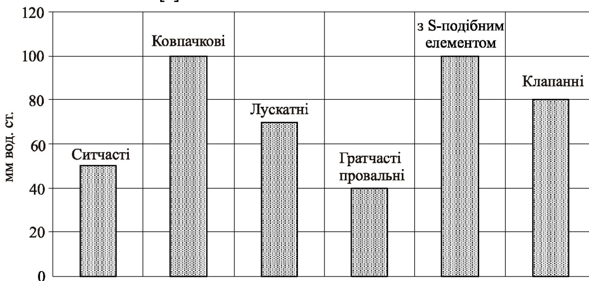
Рис. 2. Гідравлічний опір досліджуваних тарілок
