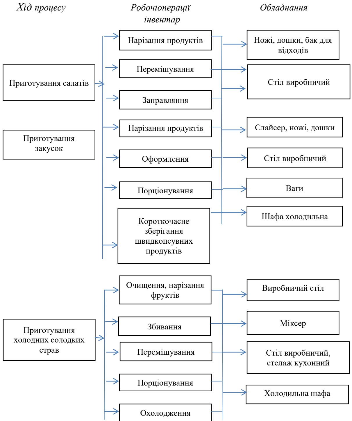
Рис.3.6 – Структурно-технологічна схема виробничого процесу холодного цеху
