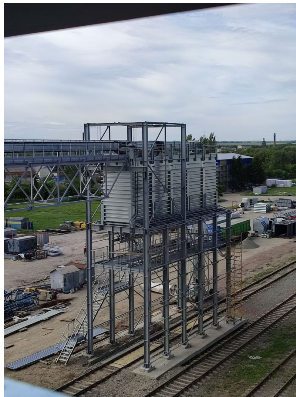
Рисунок 1.1 - Загальний вигляд системи вивантаження зерна у залізничні вагони
