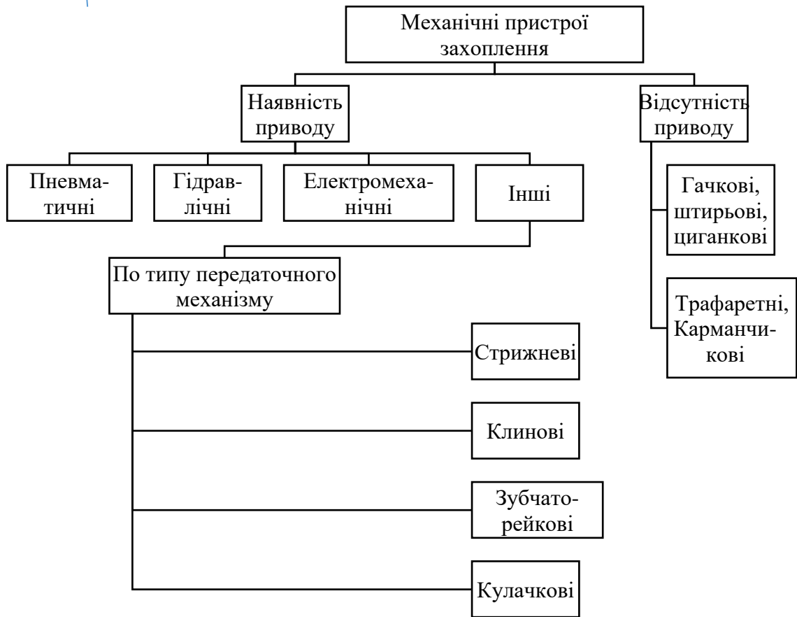
Рис. 3.6. Класифікація механічних пристроїв захоплення ПР
