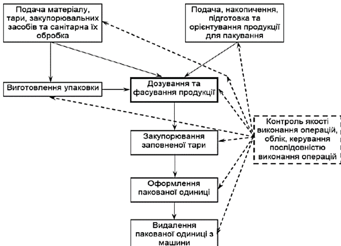
Рис. 1.14 – Технологічний процес пакування готової продукції
