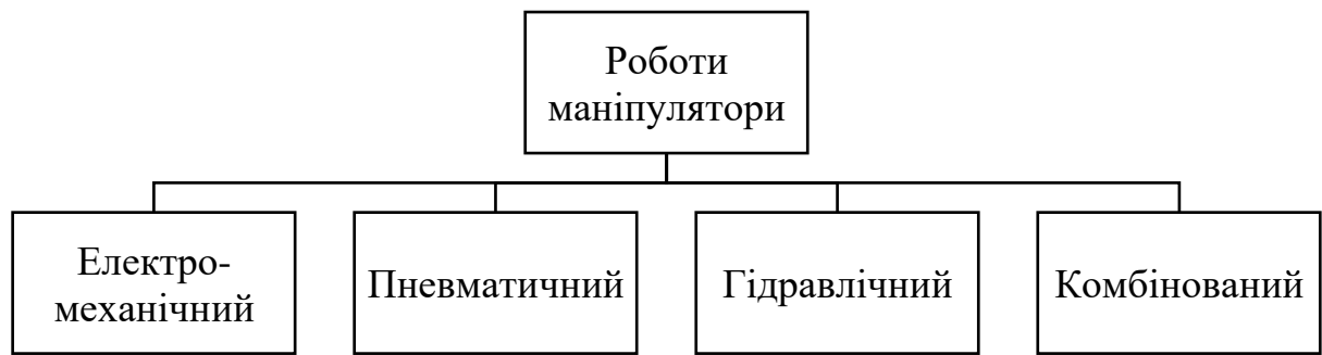
Рис.2.4. Класифікація РМ за типом силового приводу
