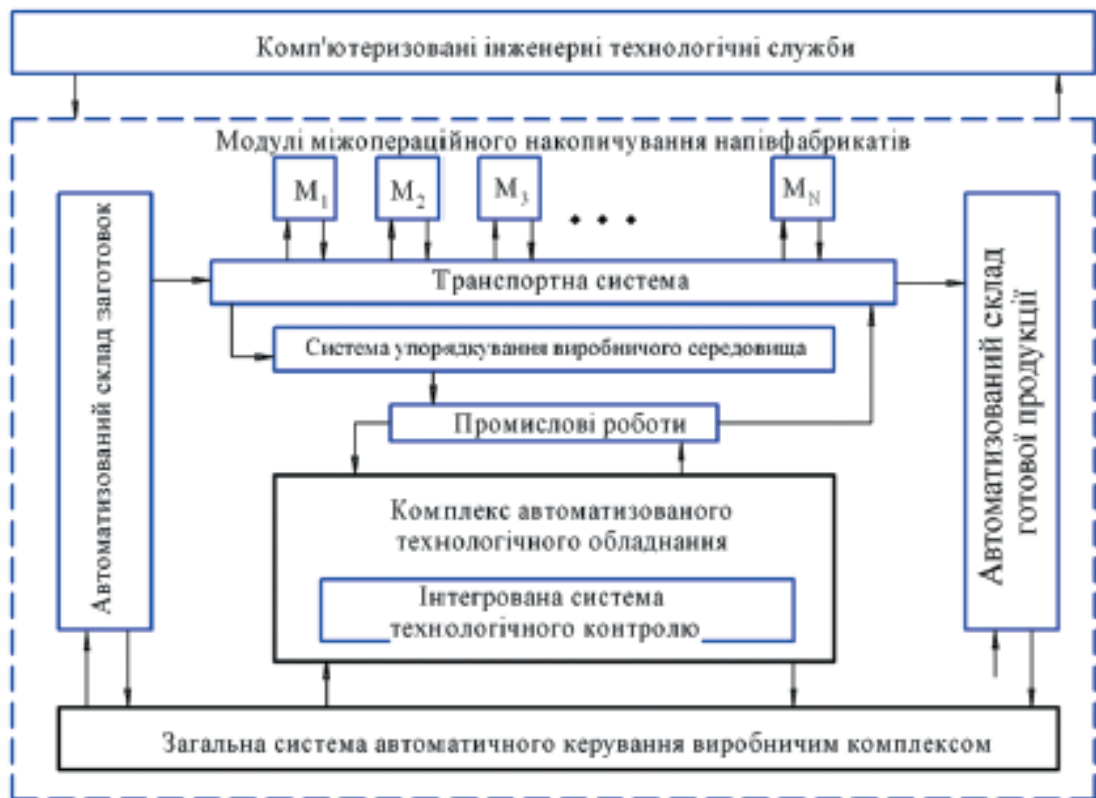
Рис. 1.2. Узагальнена схема РТС
