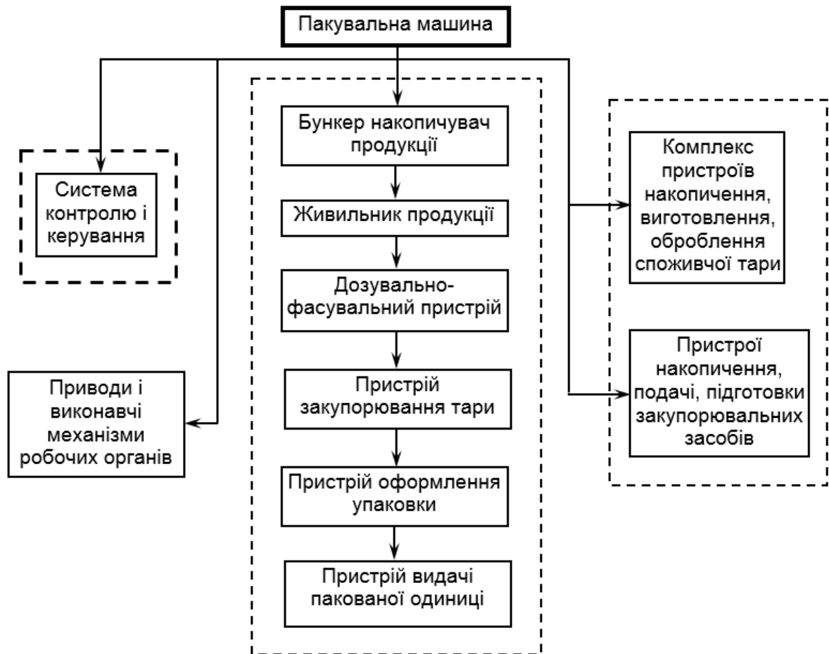
Рис. 1.15 – Структура пакувальної машини
