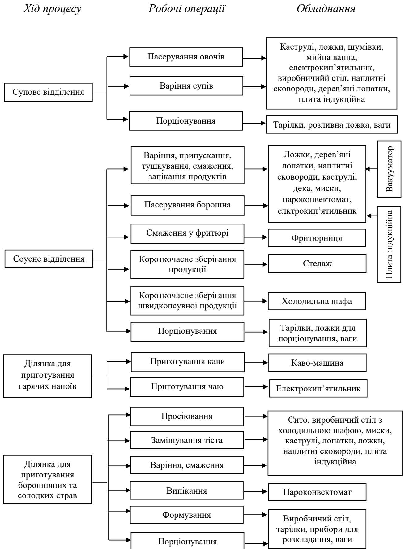
Рис.3.6 - Структурно-технологічна схема виробничого процесу гарячого цеху
