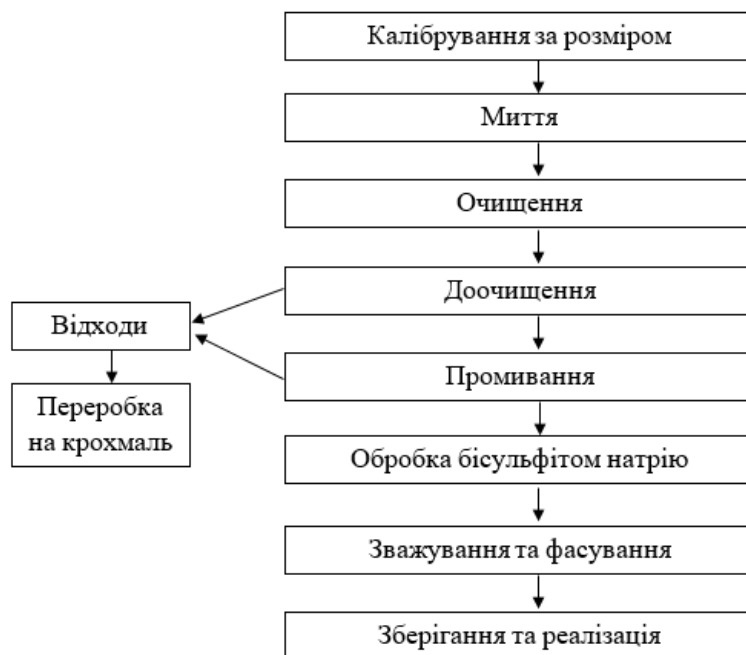
Рис.1.1 – Схема обробки картоплі
