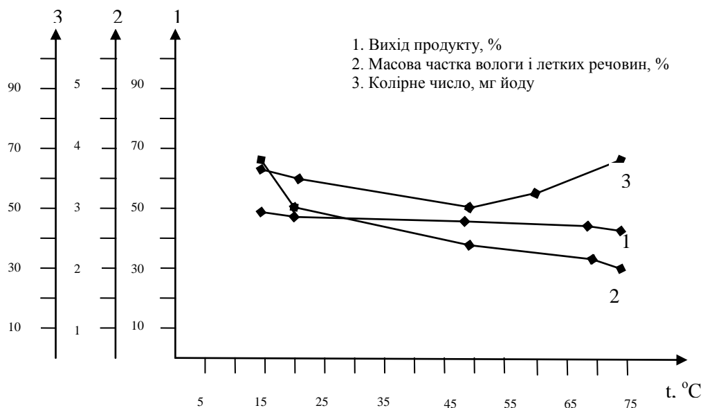
Рис. 1. Визначення температурного режиму екстрагування ФК з 10 % ліпідної добавки з омега-3 жирними кислотами при гідромодулі на першій стадії 1:1 та наступних – 1:2
