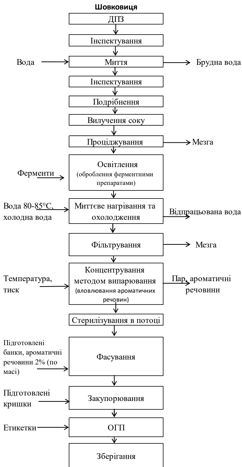
Рис.4.1. Принципово-технологічна схема виробництва «Соку концентрованого із шовковиці»
