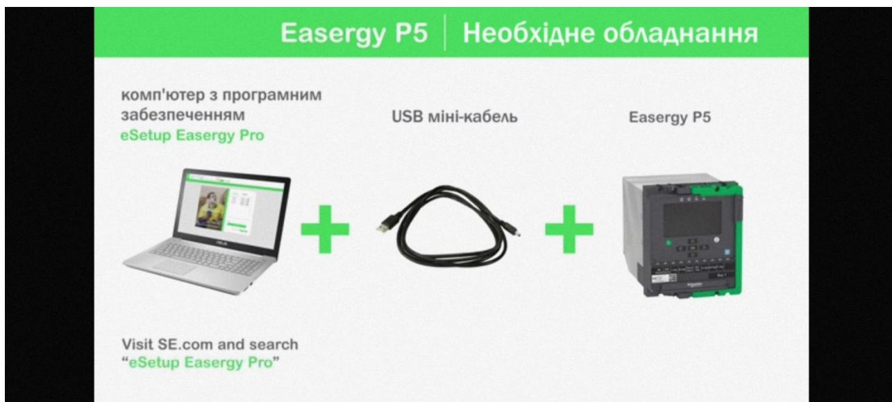
Рисунок 22. Комплектація пристроїв необхідна для віртуального інжекційного тестування
