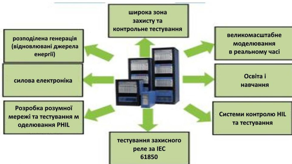
Рисунок 17. Можливості цифрового симулятора реального часу (RTDS)
