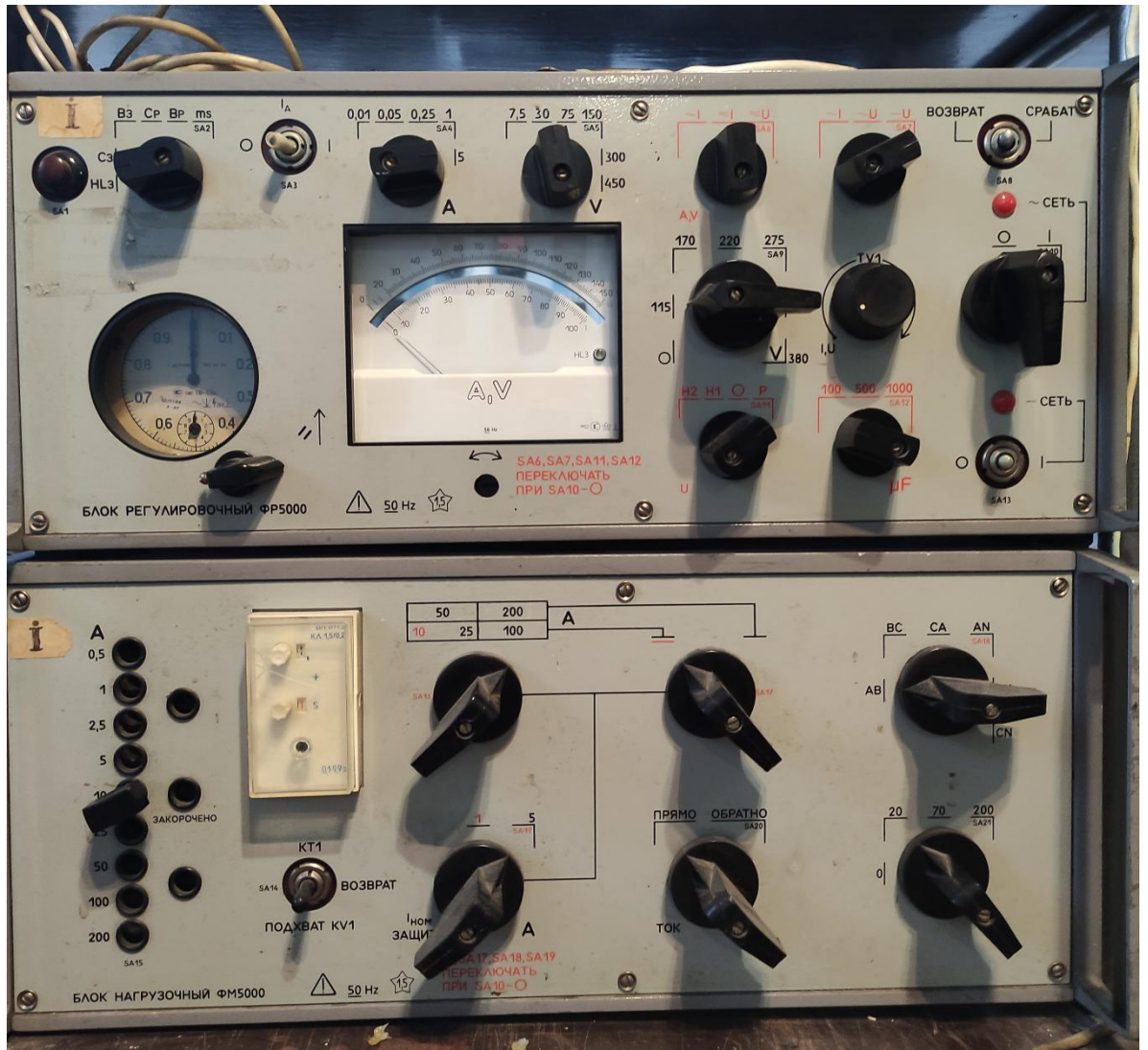
Рисунок 1. Установка ЭУ5000 (з двух блоков: ФР5000 та ФМ5000)
