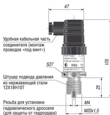
Рисунок 4.2 – Габаритні розміри пневматичного перетворювача АКУТЕК ПД100-ДИ
