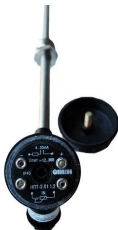
Рисунок 2.2 – Термоперетворювач опору ДТС типу ТСМ 100М із вбудованим нормуючим перетворювачем температури НПТ-2
