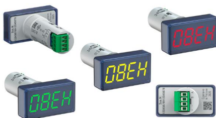
Рисунок 2.7 — Світлодіодний індикатор СМІ2
