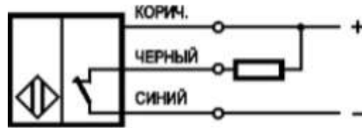
Мал.2.4. Схема підключення OS A45A-32N-10-LZ.
