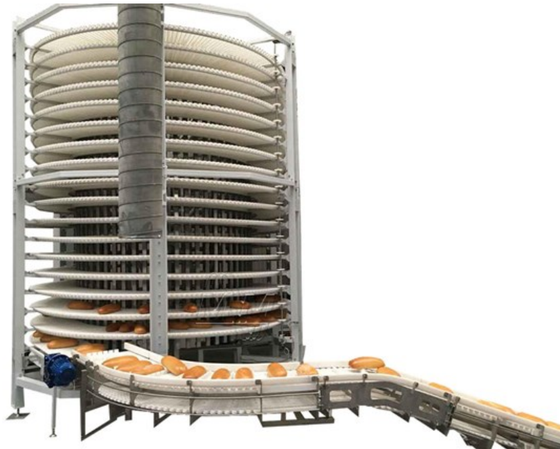
Рис. 1.2. Спіральний охолоджувач для хлібобулочних виробів, що забезпечує безперервне та рівномірне охолодження продукції під час руху по спіралі.
