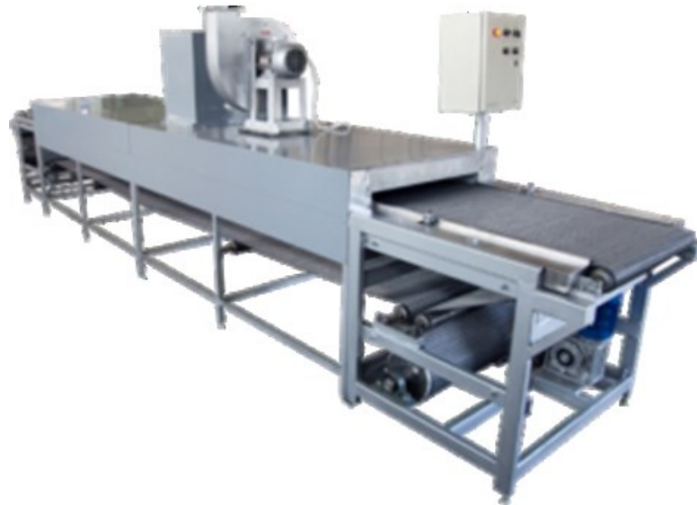
Рис. 1.3. Охолоджувальний конвеєр КОХ-2 для хлібобулочних виробів із застосуванням кондиціонованого повітря, що забезпечує рівномірне та ефективне охолодження продукції під час транспортування по конвеєру.
