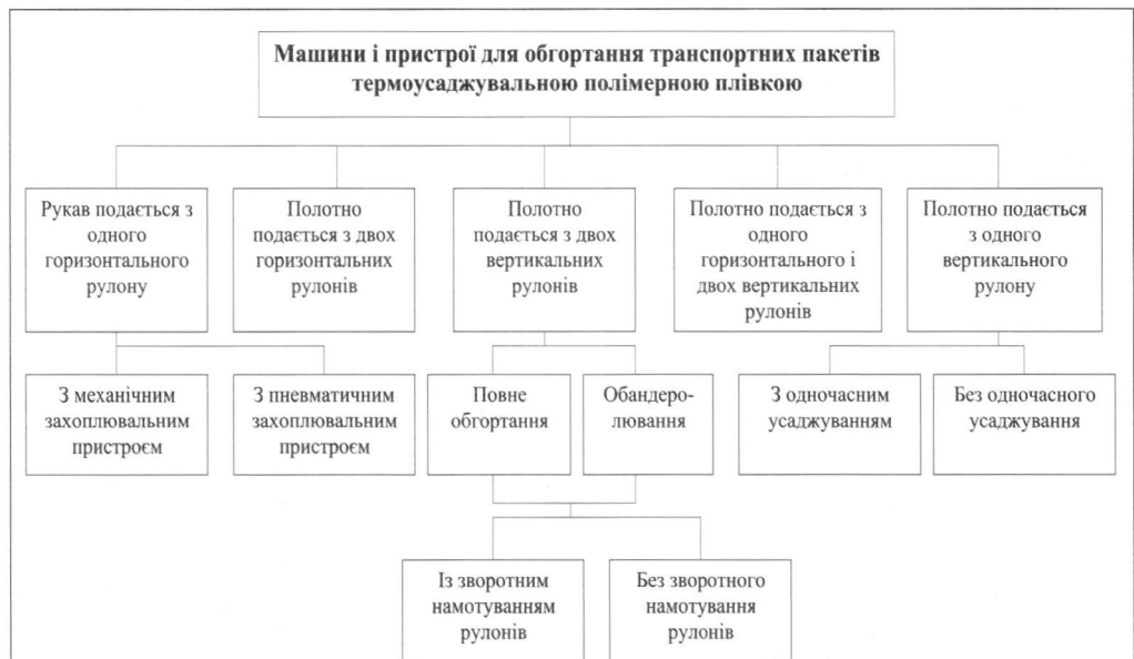
Рис. 1. Класифікація машин і пристроїв для обгортання транспортних пакетів термоусаджувальною плівкою
