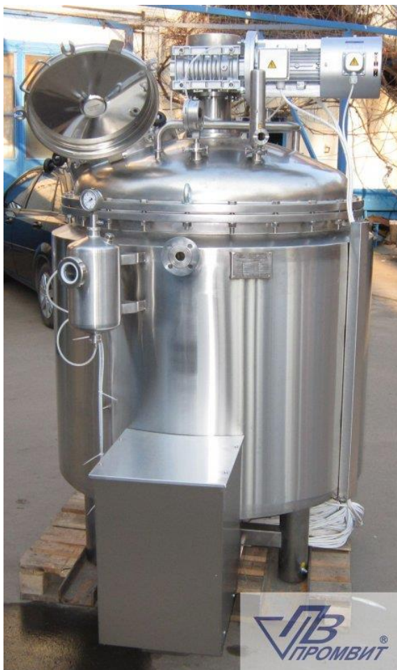
Рисунок 2.6. Емальований сульфуратор з охолоджувальною сорочкою та пропелерною мішалкою.
