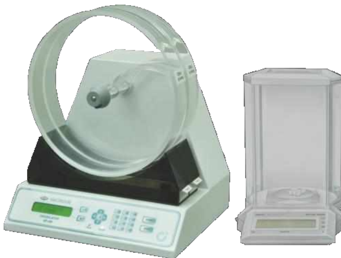
Рис 4.5. Обладнання для перевірки стираності таблеток [136]
