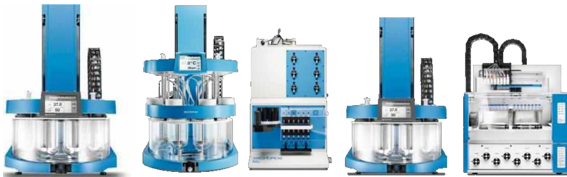
Рис 4.4. Обладнання з лопаттю з різними рівнями автоматизації:
