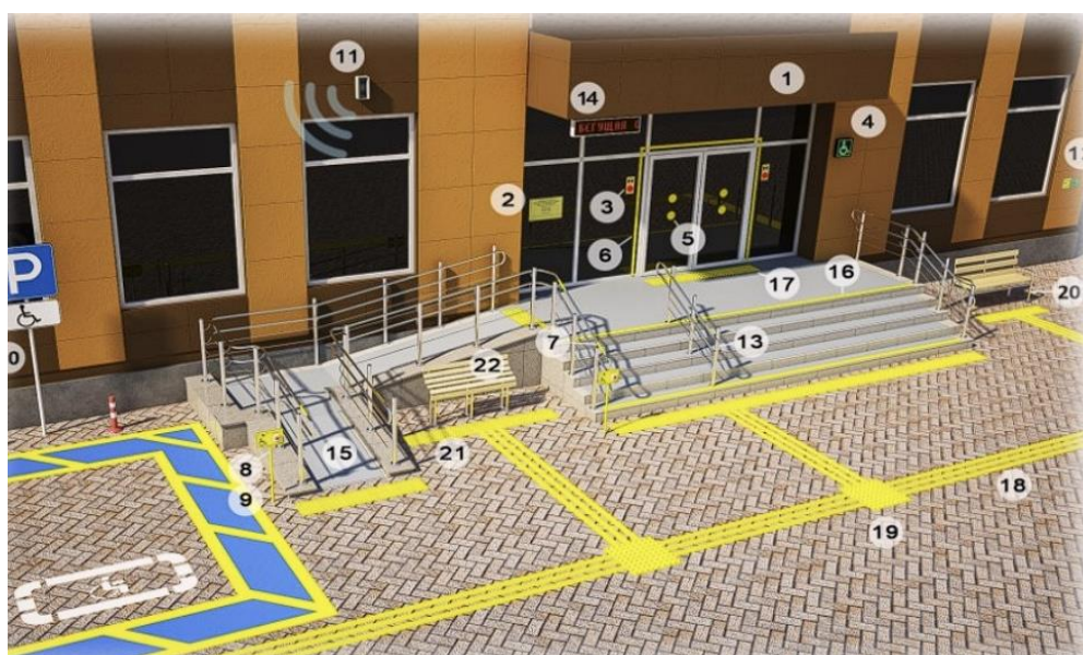
Рис. 4.2 Комплекс елементів доступності та безбар'єрного середовища при вході до еко-готелю для маломобільних груп населення
