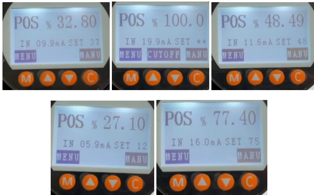
Рис. 3.2.1. Проміжні положення сідла клапану під час регулювання потоку.
