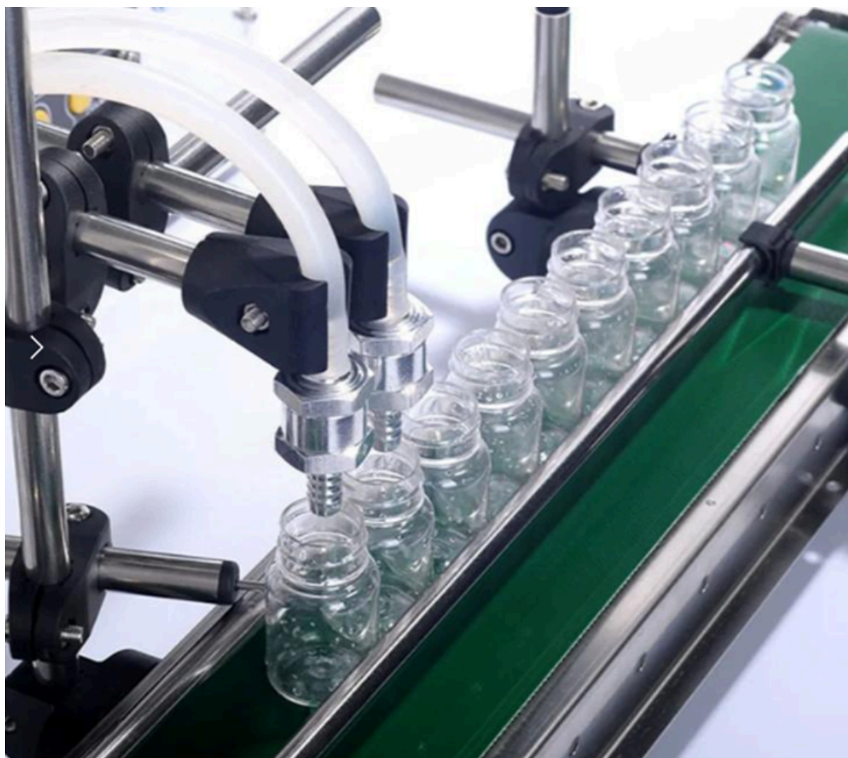
Рис. 3.1. Дозування на установці за принципом безперервної дії
