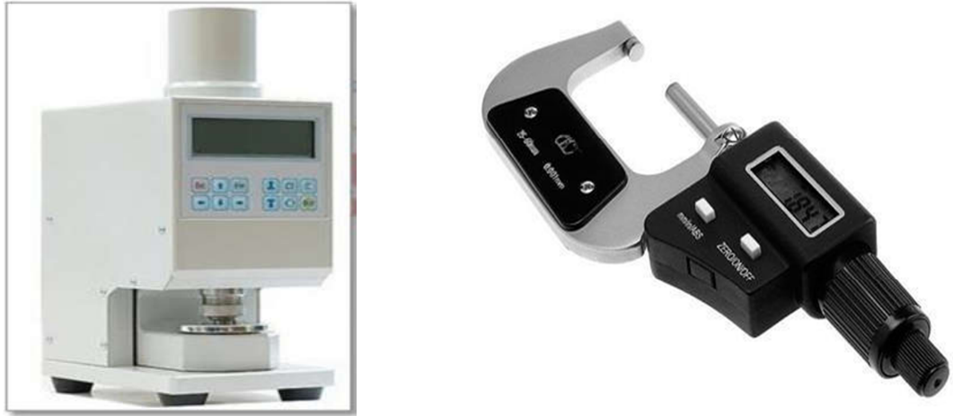
Рис. 3.2. Пристрої для вимірювання товщини заготовок
