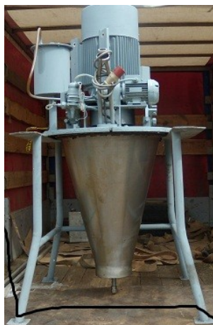
Рис.5.9 Сушарка розпилююча відцентрова [74].
