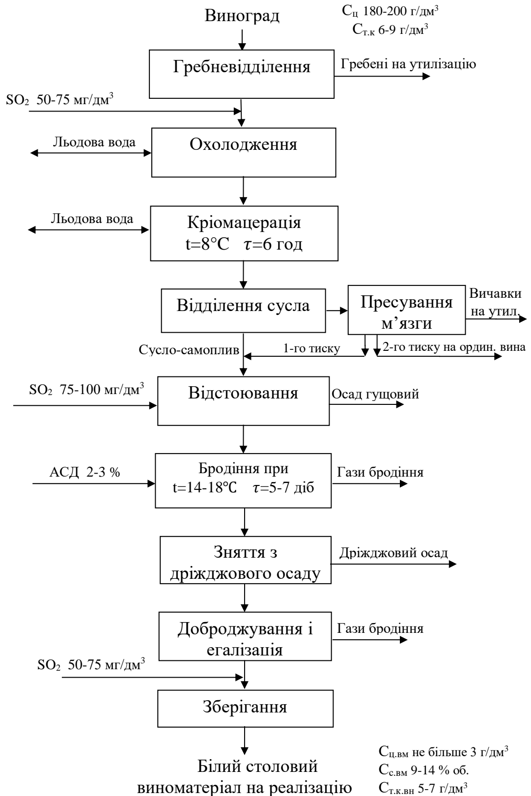
Рис. 2.1- Принципова технологічна схема виготовлення білих сухих виноматеріалів
