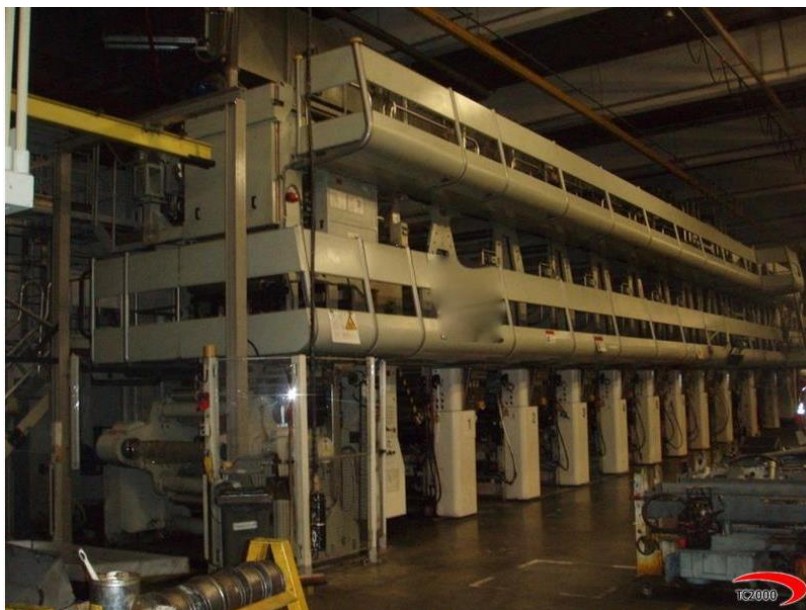
Рис.4.4 Машина глибокого друку ROTOMEC 4000-2 ES 1220/400/С для гнучкої упаковки
