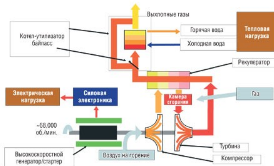
Рисунок 4.3 - Схема когенераційної установки
