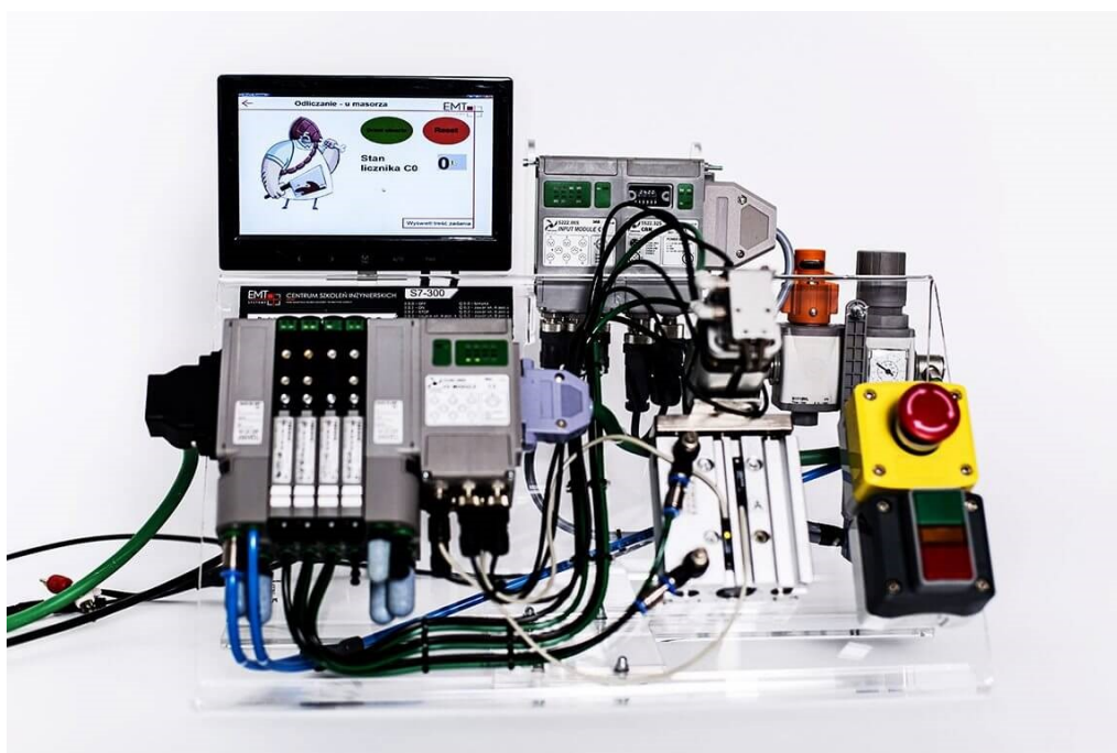
Рисунок 6.1 –Промисловий контролер SIEMENS SIMATIC S7-300/400
