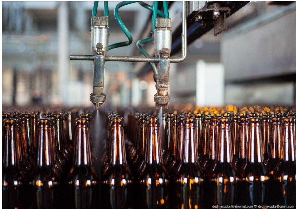
Рис. 4.3.1.1.11 – Обробка тари захисною рідиною
