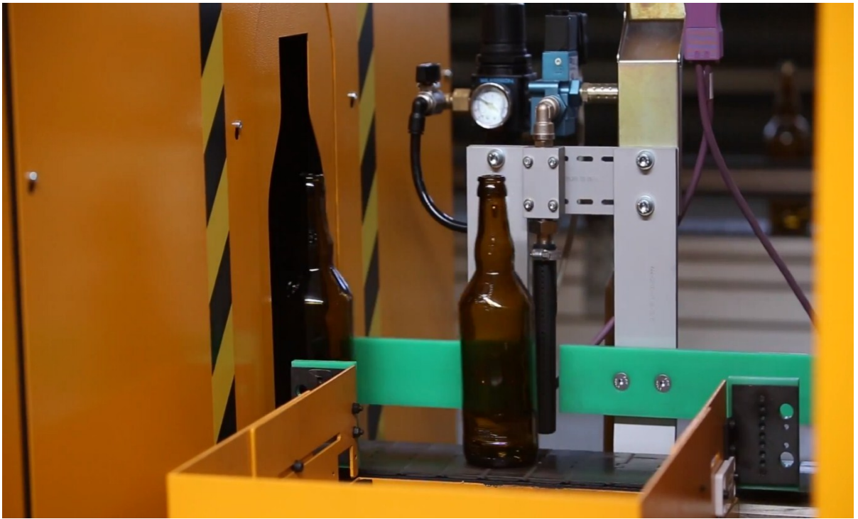
Рис. 4.3.1.1.13 – Машинний контроль якості тари
