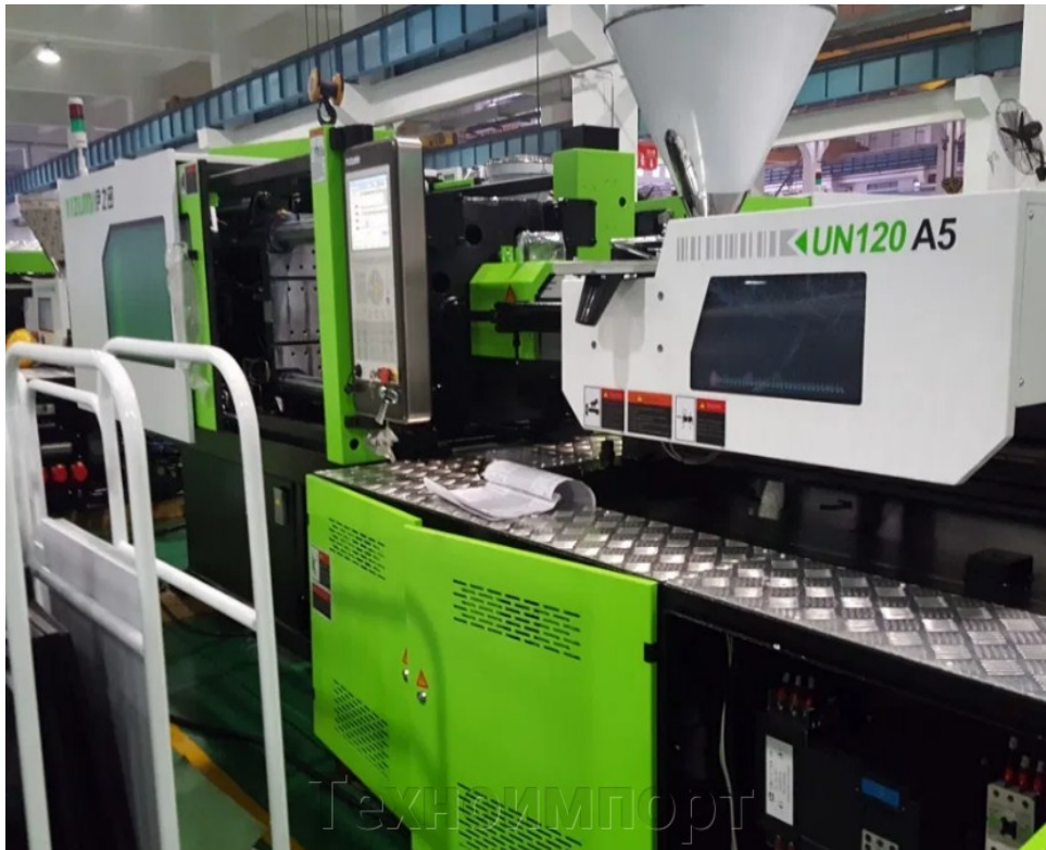
Рис. 4.3.1.2.1 – Термопластавтомат моделі Yizumi UN120A5
