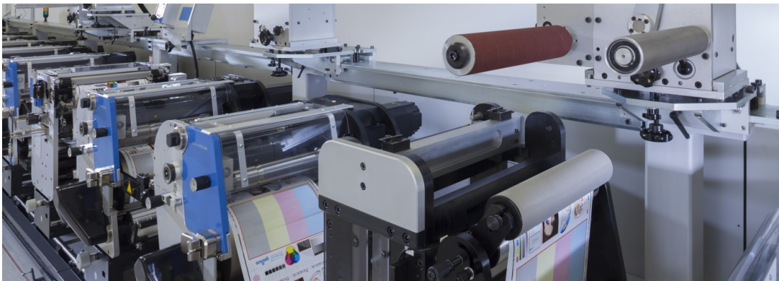
Рис 4.3.2.1 – Машина флексографічного друку Gallus ECS340.
