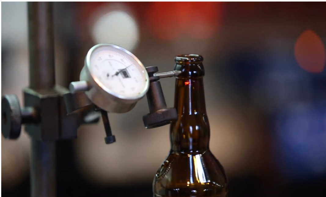
Рис. 4.3.1.1.12 – Перевірка горловини на точність виготовлення
