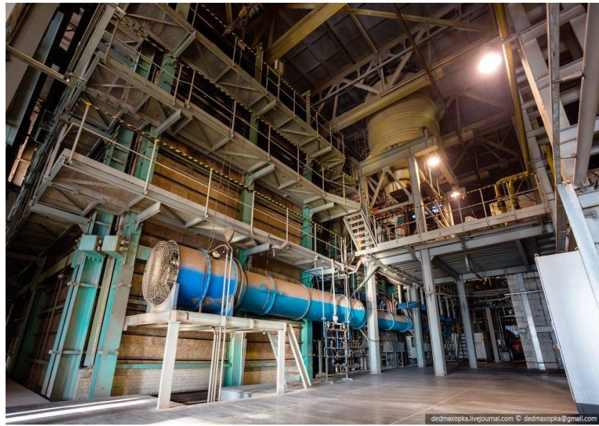
Рис. 4.3.1.1.5 – Піч для скловаріння ванного типу
