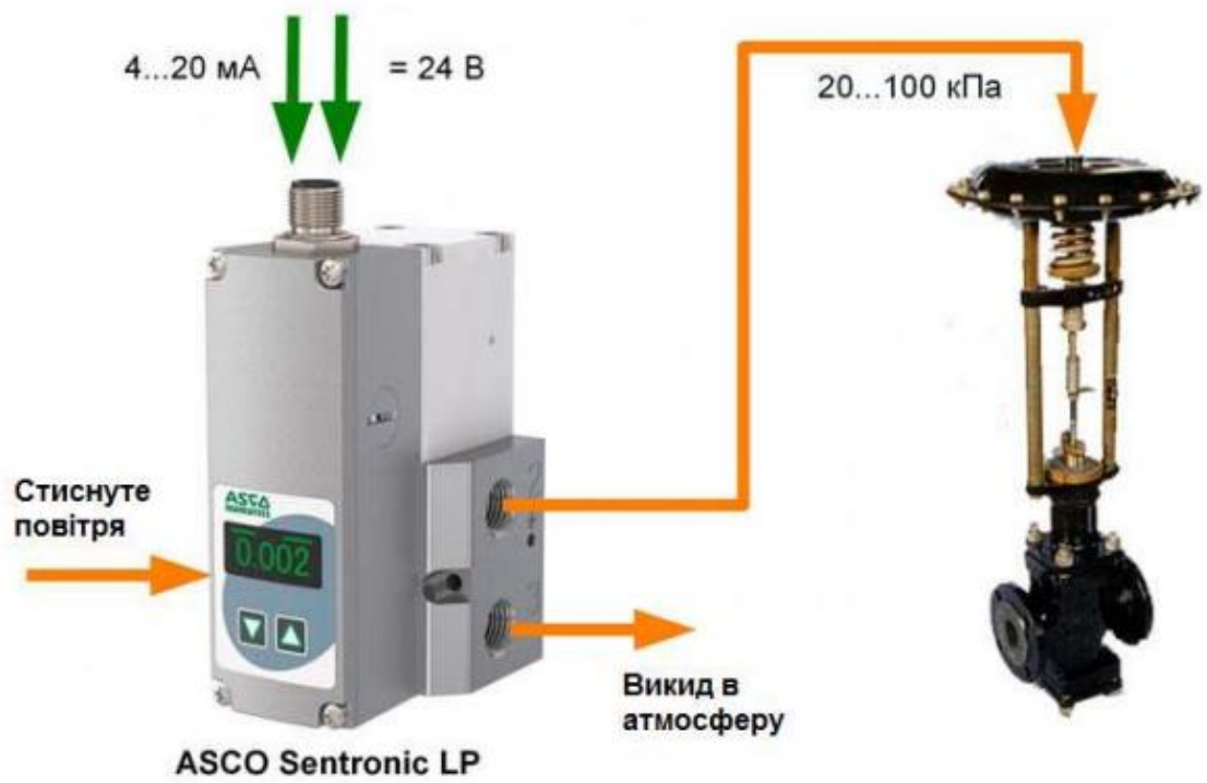
Рис. 2.9. Схема підключення ASCO NUMATICS Sentronic LP та клапану.
