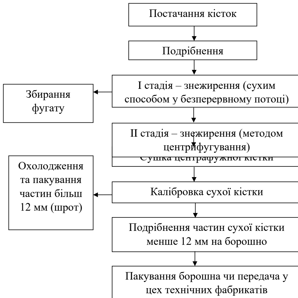
Рис. 4.2. Принципова технологічна схема комплексної переробки кісток [115].
