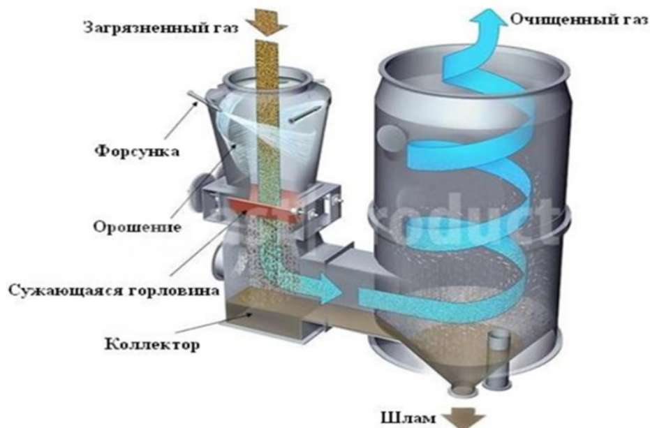
Рис. 10.1. Конструкція скрубера Вентурі [101].
