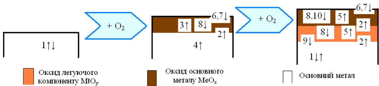
Рис.1. Схема утворення зони внутрішнього окиснення за О.Кубашевським, і Б.Гопкинсом.
