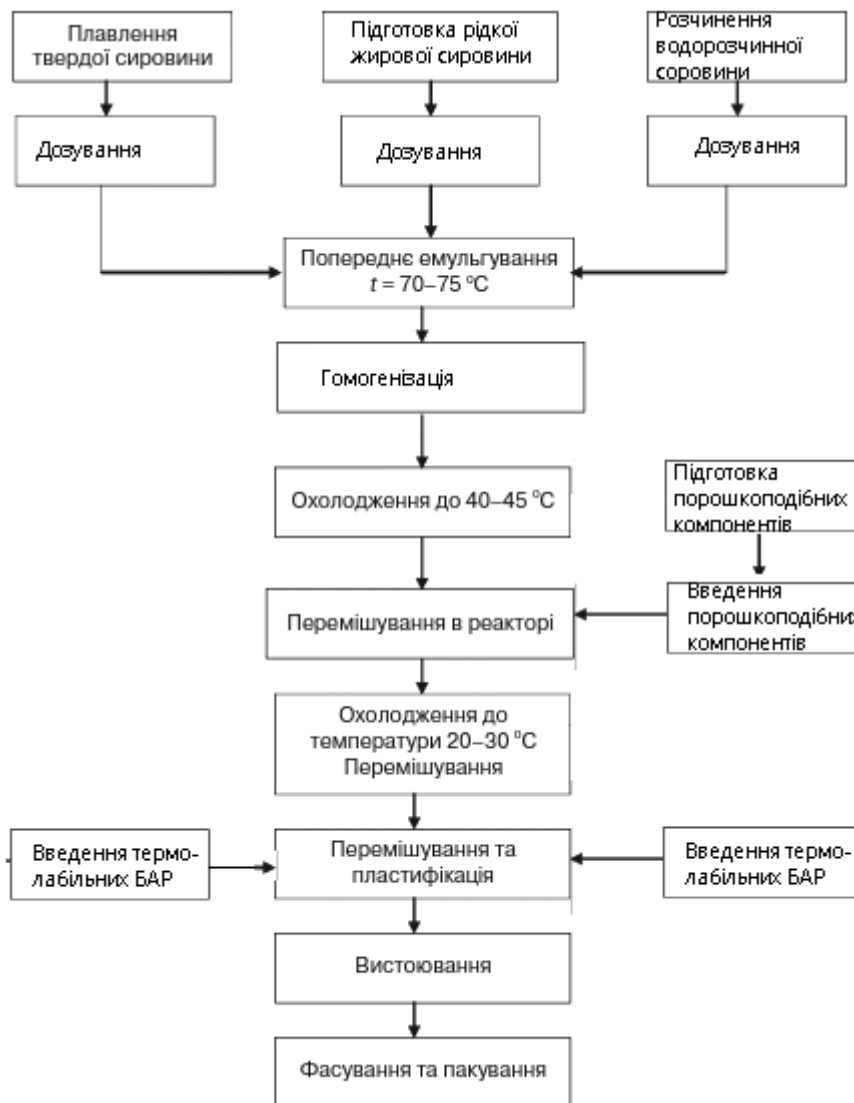
Рис. 2.1. Принципово-технологічна схема виробництва
