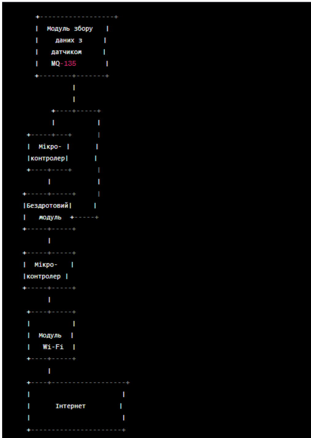
Рис. 6. Принципова схема частини прийому та передачі даних в Інтернет.
