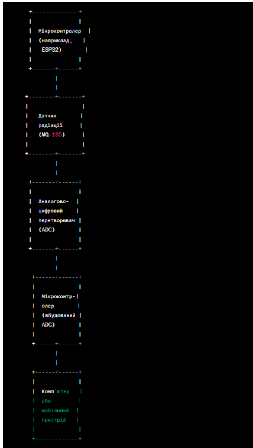
Рис.5. Принципова схема частини збору даних електронної системи моніторингу вуглецю з датчиком MQ-135.
