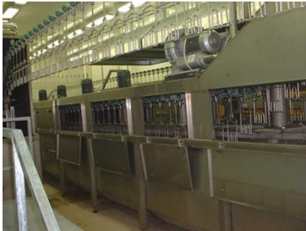
Рис. 4.3- Апарат для теплової обробки тушок
