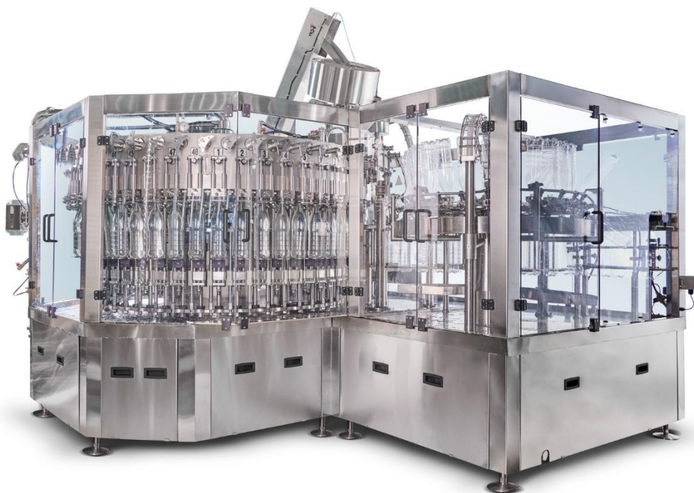
Рис. 1.1. Триблок фасувально–закупорювальної машини з попередніми етапами обполіскуванням
