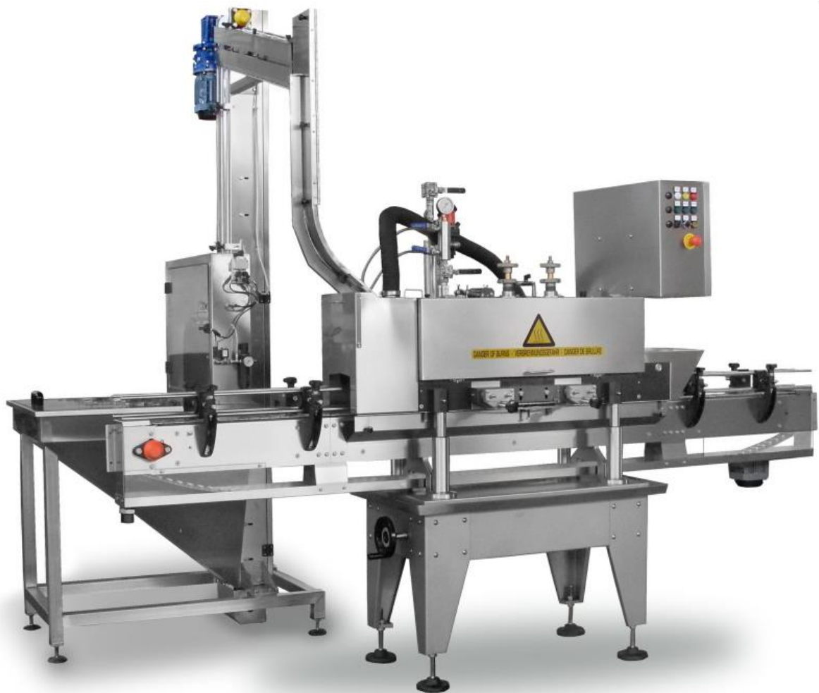
Рис. 1.5. Автоматична закупорювальна машина для закупорювання кришкою RTO
