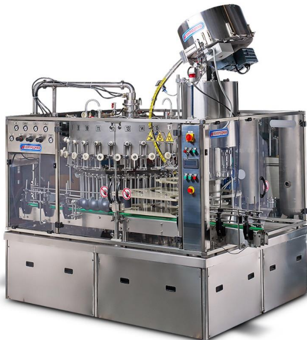
Рис. 1.2. Моноблок фасувально–закупорювальної машини з попередніми етапом обполіскуванням
