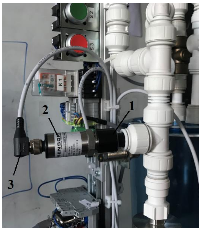
Рис.2.9 Аналоговий датчик тиску BDSensors 26.600G : 1 – перехідний патрубок; 2 – корпус датчика; 3 – роз'єм 4-х піновий;
