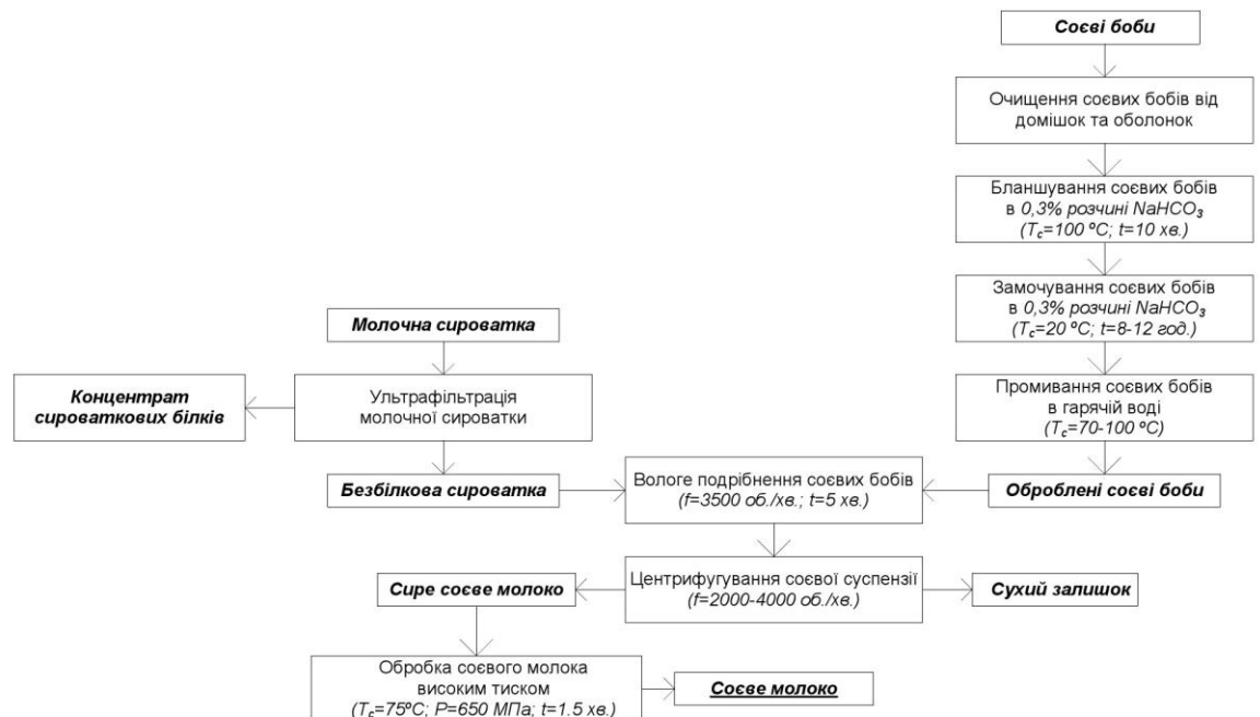
Рис. 2.1. Принципова схема виробництва соєвого молока на основі безбілкової сироватки
