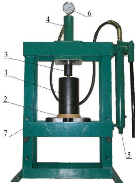
Рисунок 3.2 - Лабораторна установка для пресування жому: 1-циліндр; 2-перфороване дно; 3-шток; 4-гідравлічний; 5-насос; 6- манометр; 7-рама
