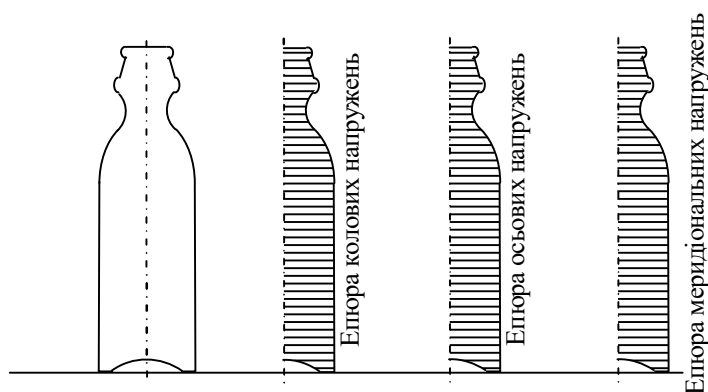
Рис. 1.16. Ілюстрація до побудови епюр колових, осьових і меридіональних напружень
