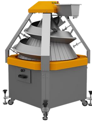
Рисунок 1.10 – Тістоокруглювач з регульованими жолобами SM3100, Україна [20]
