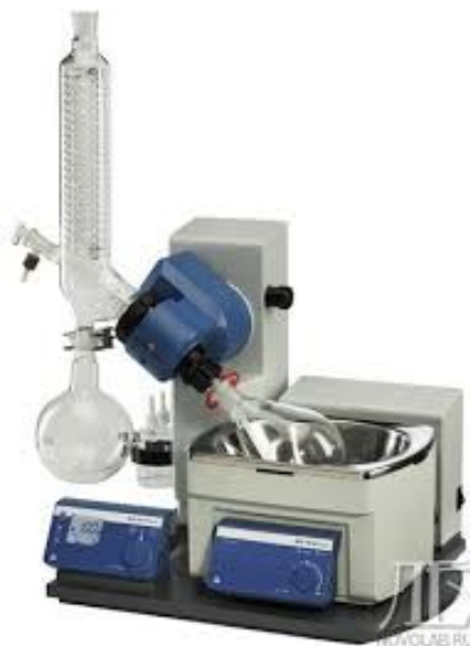
Рис. 2.2 Роторний випарник ІКА RV10 control
