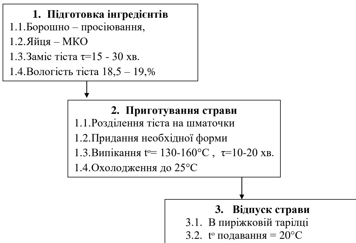
Рис. 3.2. Алгоритм операцій по виробництву пісочного печива
