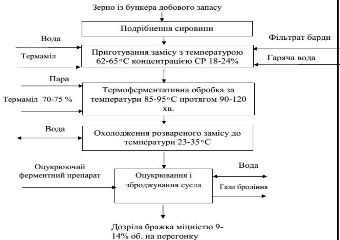
Рис.2.1 — Принципова технологічна схема отримання дозрілої бражки у виробництві спирту з крохмалевмісної сировини
