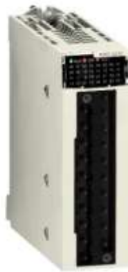
Рис.3.2. Зовнішній вигляд модуля аналогових входів ВМХ АМІ 0800
