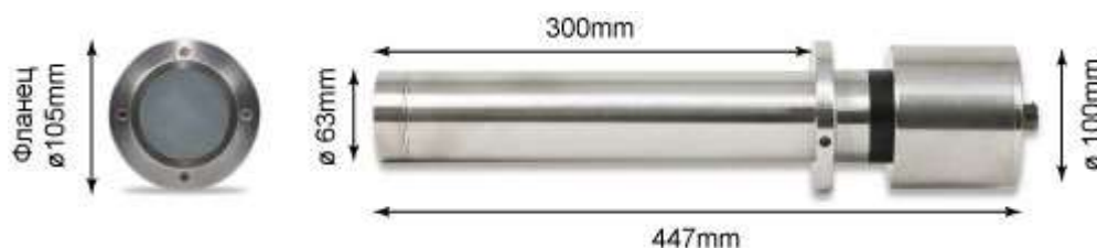
Рис.4.4. Габаритні розміри датчика вологості
