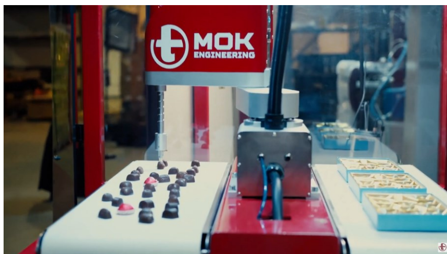
Рисунок 4.6 Вакуумний маніпулятор «Скара» компанії «МОК Engineering» [25]
