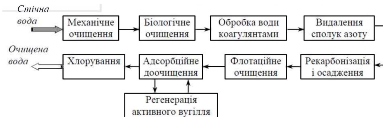
Рис 13.2. Технологічна схема споруд глибокого очищення стічних вод з використанням адсорбційних методів видалення органічних забруднень [22].
