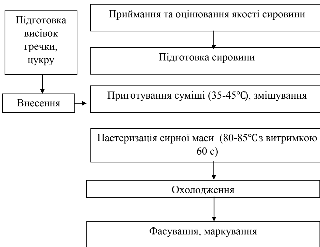
Блок-схема виробництва сиркового виробу з висівками гречки
