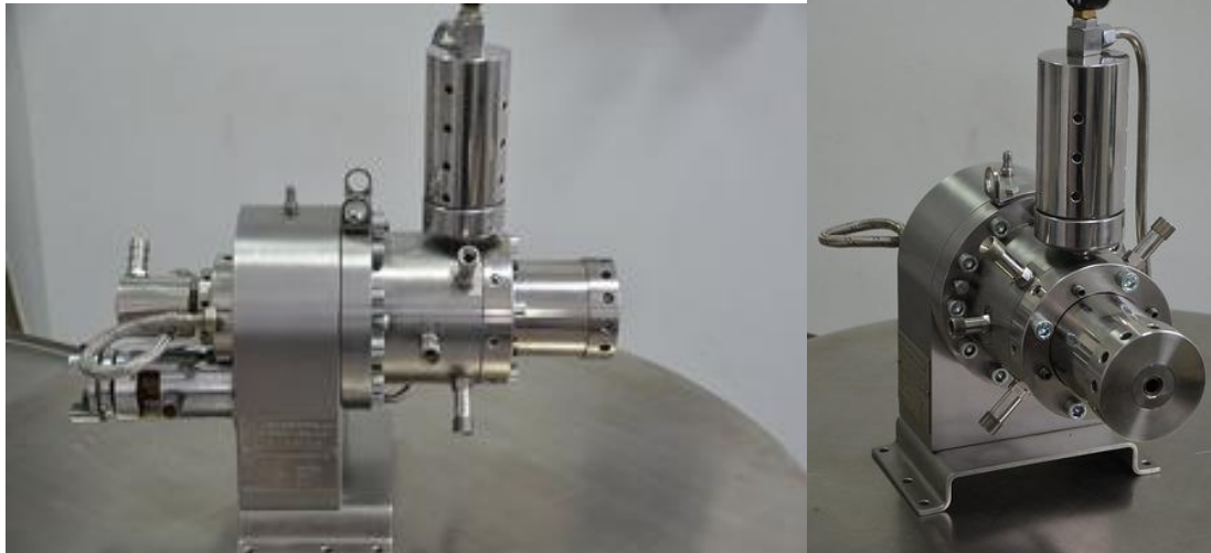
Рис.1.6 Головка для виготовлення білкових ковбасних оболонок
